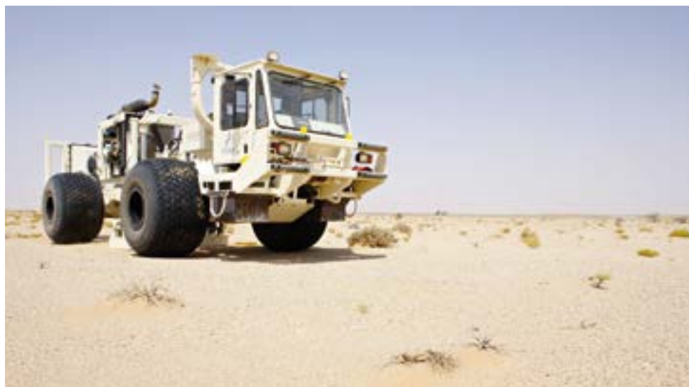
利用数字技术勘探天然气——搭载振动器的卡车在阿曼的沙漠中为BP开展地震勘探作业。
