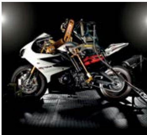
一个机器人正骑着一辆摩托车，以测试嘉实多润滑油——采用机器人可提高测试的可重复性和安全性。
